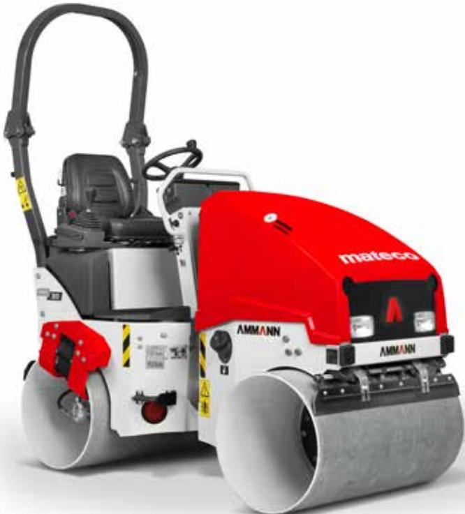
Fréquence de vibration max. **66 Hz**
