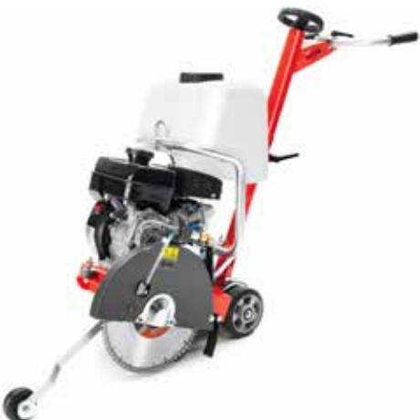
Une scie de sol à essence, poussée, très légère et compacte pour la découpe d'asphalte et de béton. Parfaite pour les chantiers difficiles d'accès et pour les petits travaux de réparation, jusqu'à 122 mm de profondeur de coupe.
